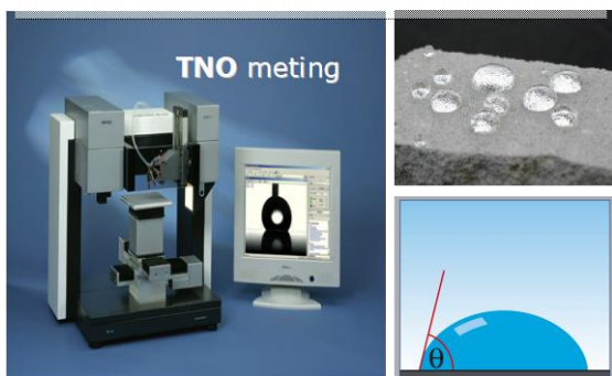
Afbeelding 2: De randhoek wordt gemeten aan een microscoopbeeld van een afgemeten druppel die op het proefoppervlak wordt losgelaten.
