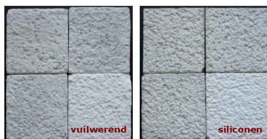
Afbeelding 6: Fotopresentatie van kunstmatige vervuilingstest. In elke set van 4 is het proefstuk rechtsonder het referentieveld (onvervuild) dat ter vergelijking is bijgevoegd. Boven: Bij veroudering neemt vervuiling op kunsthars sierpleister toe, evenals op minerale sierpleister. Midden: Bij een initiële schilderbeurt op sierpleister neemt de vervuiling sterk af. Onder: Vervuiling met roet geeft in gelijke mate vergroaving op sierpleister geschilderd met vuilwerende en siliconen verf.
