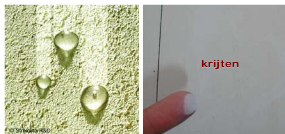
Afbeelding 3: Het afparelen van druppels op een gevelvlak is een ander mechanisme van 'schoon' blijven, dan het 'krijten' (zelfreinigen) waarbij oppervlakkig materiaalverlies optreedt.
