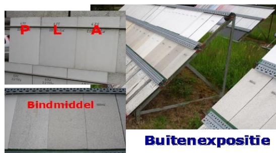
Afbeelding 4: Naast elkaar in een buitenexpositie is het onderscheid in vergraauwen van verschillende vuilwerende verfsystemen (foto linksboven: merk P, L en A) goed zichtbaar. Ook blijkt dat sierpleisters op basis van silicaat bindmiddel (foto linksonder linker proefpaneel) door het 'krijten' helderder blijven dan kunstshars sierpleister (andere twee proefpanelen).
