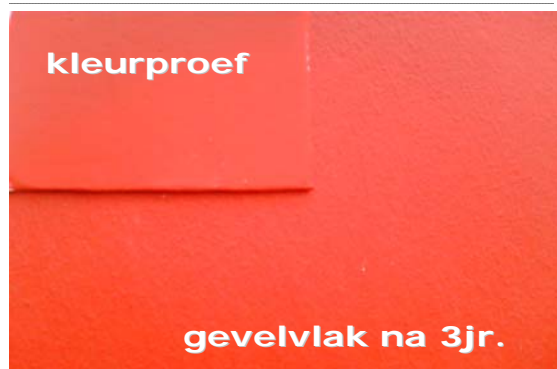
Afbeelding 7: De verkleuring van het gevelvlak die technisch niet acceptabel is, is met het blote oog niet waarneembaar in vergelijking met de originele kleur op het proefvlak.
